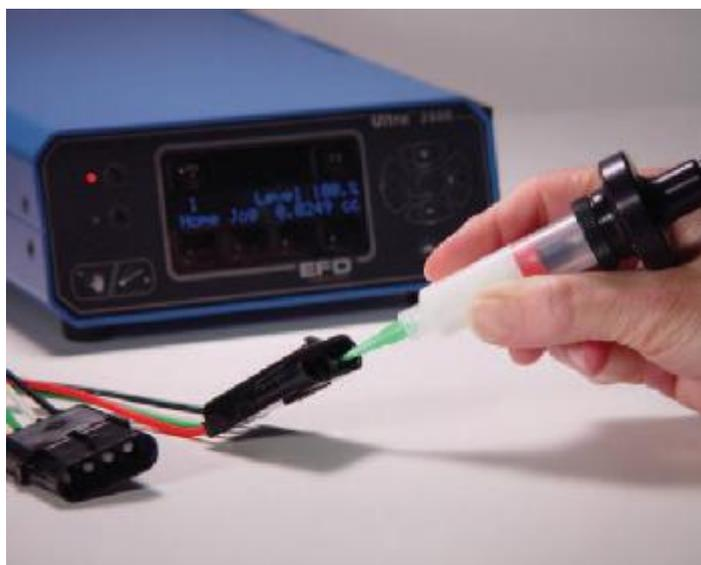
El sistema dosificador Ultra 2800 ofrece la tecnología de desplazamiento positivo para aquellas aplicaciones que requieran la aplicación de un volumen exacto de fluidos de ensamble con viscosidades que varían, o cuando se requiera de un índice de flujo específico.
